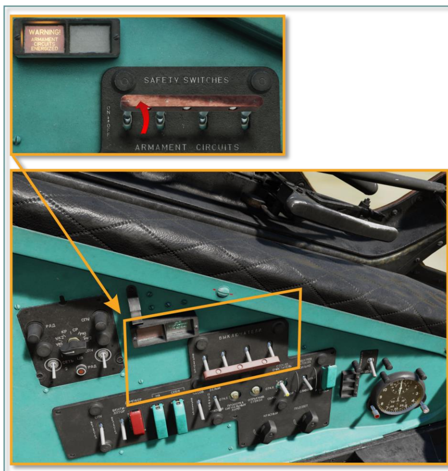
Рис. 4.12. Предохранительные выключатели и табло сигнализации их состояния
