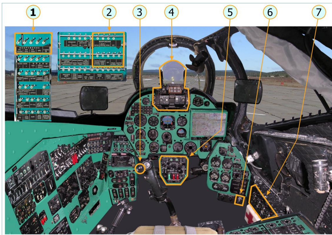
Рис. 4.2. Расположение элементов системы вооружения в кабине летчика
