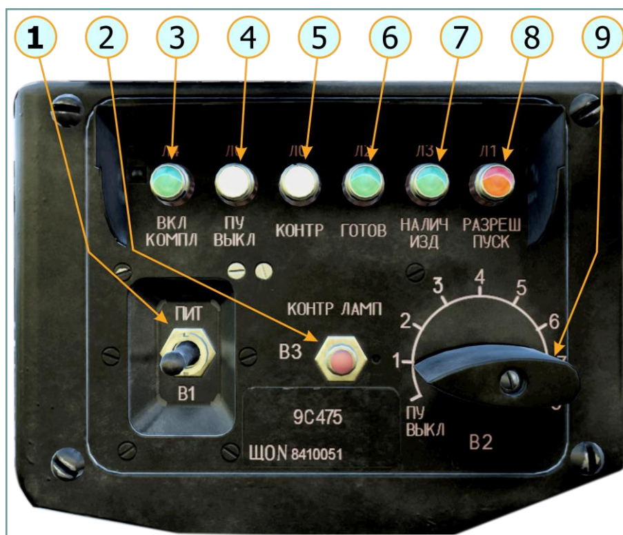
Рис. 4.16. Щиток оператора (ЩО) (Power on-off and selection missile panel)
